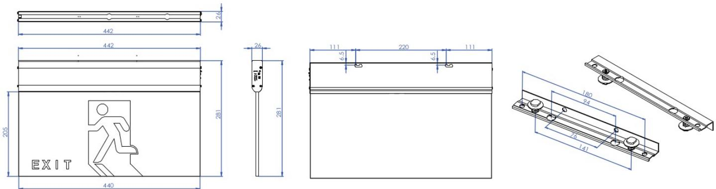
Im Normalbetrieb wird die Notleuchte über die Netzspannung versorgt. Der Akku wird während des Normalbetriebs geladen. Bei einem Stromausfall übernimmt der Akku automatisch die Stromversorgung und garantiert mindestens 3 Stunden Notbeleuchtungszeit. Schnellmontage mit der Option Easy Quick Montagebügel (Wand- und Deckenmontage)
