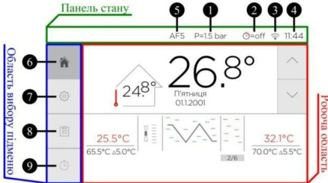
Abbildung 14.1 – Hauptbereiche der Kesselschnittstelle
