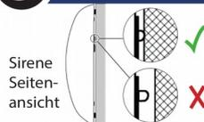
Sirene an einem sichtbaren, schwer erreichbaren Ort montieren. Auf die korrekte Funktion des Sabotageschalters achten.
