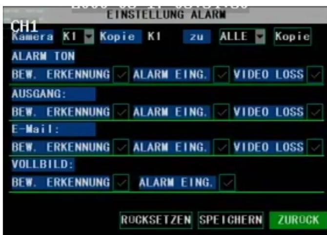
ALARM TON ... Alarm Ton bei Bewegungserkennung, Sensor Eingang bzw. Videobild Verlust
